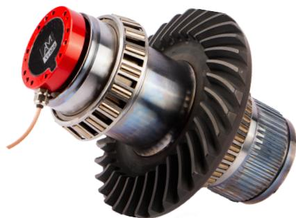
Rögelberg Getriebe mit integriertem TelMA Torque System zur Drehmoment-, Temperatur- und Drehzahlerfassung
